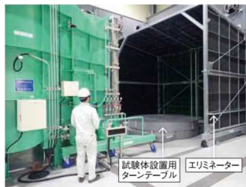
図 2-1-27 大型送風散水試験装置 2-1-31)
