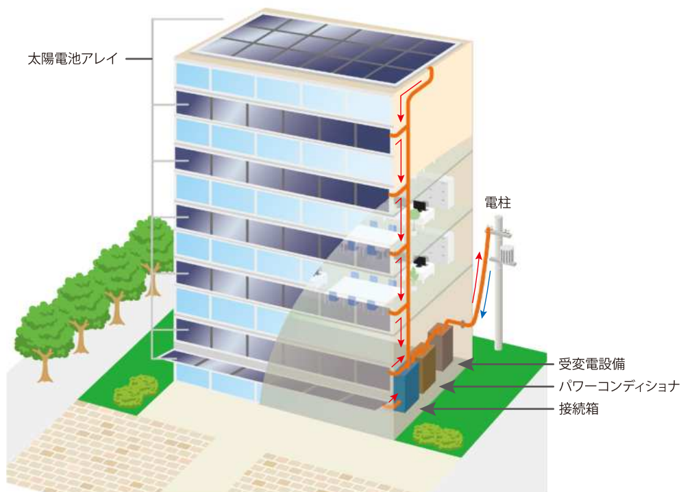
図 3-2-20 PV システムの基礎的な構成
