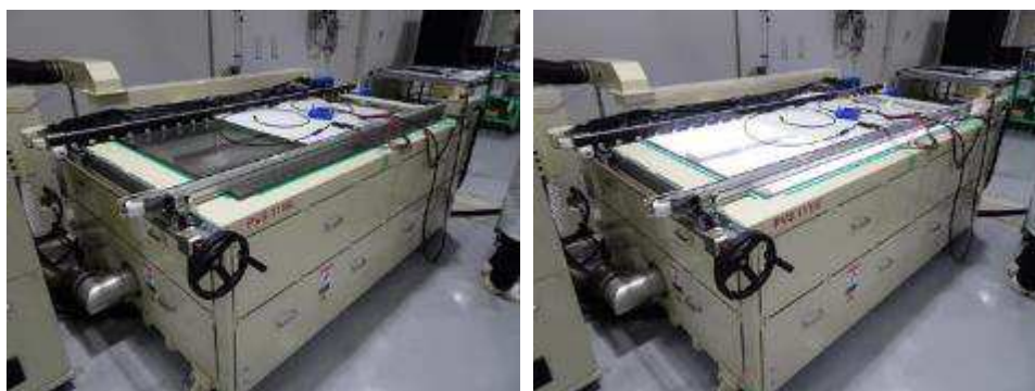
図 2-2-4 卓上型ソーラーシミュレーターによる PV モジュールへの光照射
