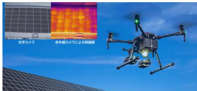
図 8-6 ドローン+赤外線カメラによる熱画像例 8-3)
