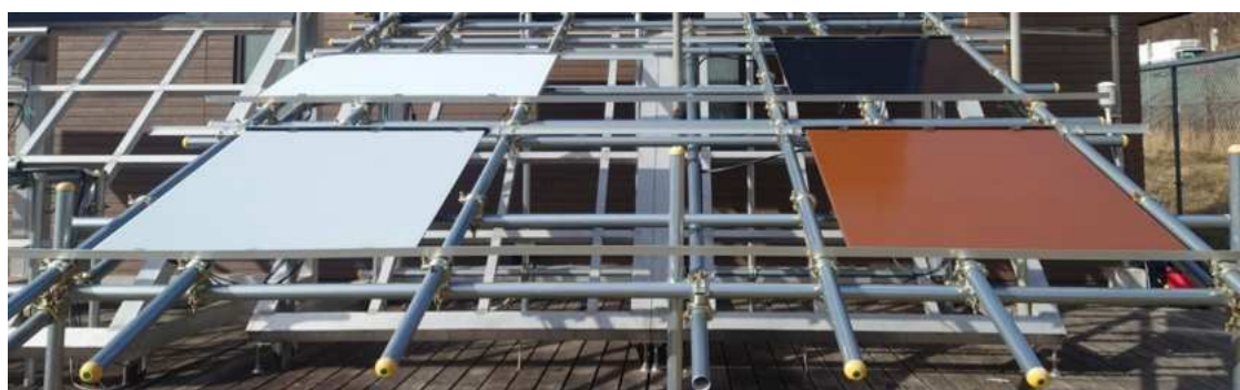
① 屋外評価用に設置された着色モジュール 右上: グレー, 右下: テラコッタ, 左下: 白
