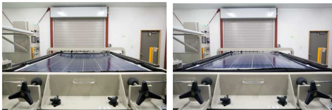
図 2-2-24 静的荷重試験 左：正方向荷重（下向き） 右：負方向荷重（上向き） 2-2-2)
