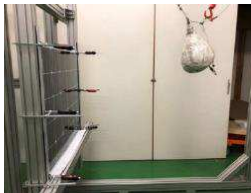
図 2-2-23 衝撃破壊試験 2-2-2)
