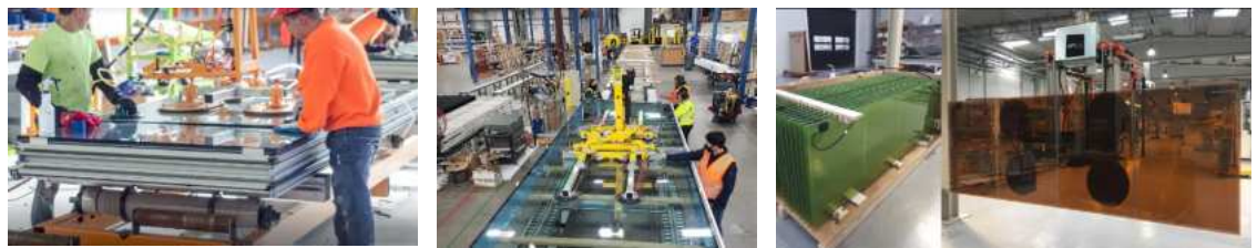
完全ユニット工法の製作過程 5-2-3)、5-2-4) BIPV モジュールのセット 5-2-5)
