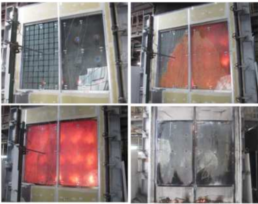
図 2-1-9 BIPV における防火試験の様子 2-1-10)
