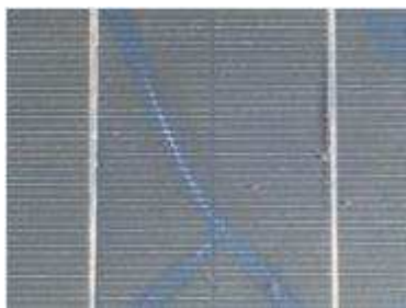
図 2-2-7 屋外暴露による セル割れ 2-2-3)
