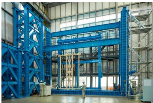
図 2-1-34 多層構面用水平加力試験装置 2-1-38)
