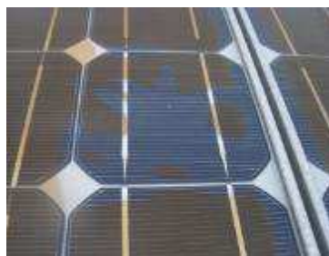
図 2-2-8 屋外暴露による封止材の剥離 2-2-3)
