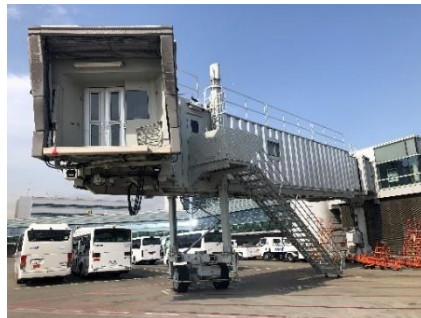
図：放射冷却素材を用いたフィルムを施工された PBB
