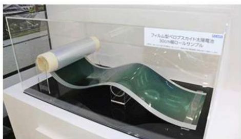
図 4-24 ペロブスカイト太陽電池（例 1）
