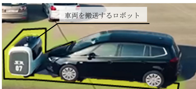
図 7-11 車両の自動搬送・駐車技術
