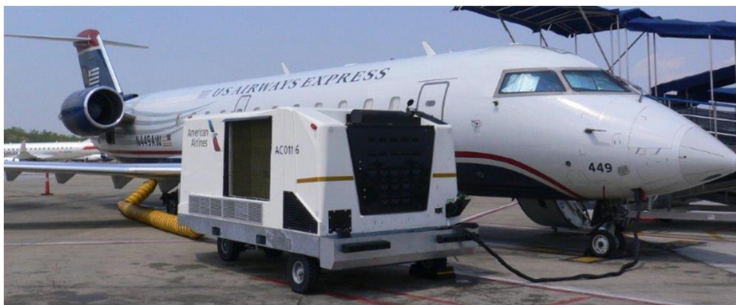
図 5-6 航空機に接続するコンボ型の移動式 GPU
