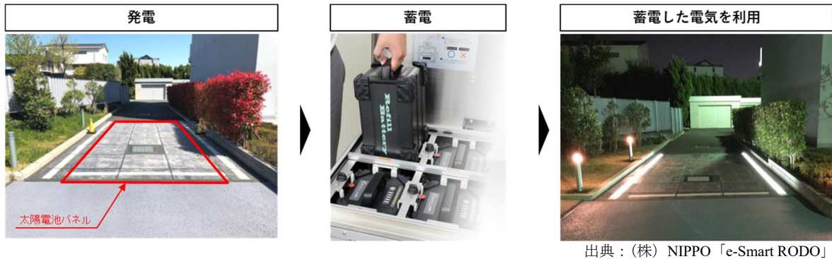
図 4-27 路面型太陽電池の活用モデル
